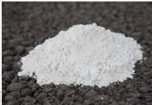
Les additions minérales, tels les laitiers moulus de hauts fourneaux permettent de réduire la chaleur d'hydratation et améliorent la résistance du béton vis-à-vis de la RSI.
